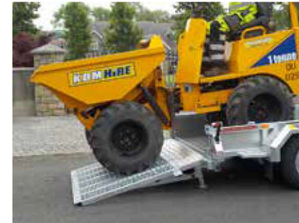
Släpets låga tyngdpunkt med en flakhöjd på endast 403mm ger en bra lastvinkel. Detta underlättar av och pålastning av maskiner med låg markfrigång.
